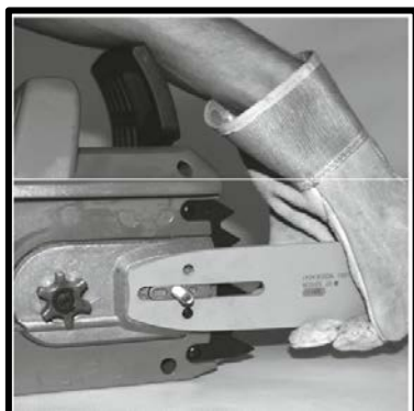
(1)-Линейка; (2)- Зазор; (3)- Нет зазора; (4)-Отклонение цепи.
